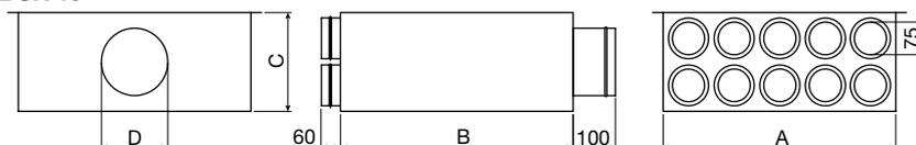
Plenum di distribuzione dell'aria dotato di 1 attacchi principali DN200, 10 attacchi secondari per tubo corrugato DN75.
