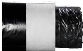
Tubo flessibile interno realizzato con film in resina poliolefinica e armatura a spirale in filo di acciaio armonico ricoperto con PVC incorporata tra due strati termosaldati. Materassino isolante in fibra di poliestere sp. 25 mm e densità 18 kg/mc. Rivestimento esterno in foglia di resina poliolefinica. Temperatura di esercizio da -20°C a +75°C. **Fornitura in pezzature da 10 m.**
