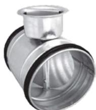
Serranda di intercettazione e taratura a regolazione manuale, in lamiera di acciaio zincato con chiusura a tenuta. Completa di maniglia e dotata di guarnizione a doppio labbro in EPDM resistente all'invecchiamento. Facilmente installabile nei sistemi canalizzati circolari e può essere montata in tutte le posizioni. La pala può essere regolata da 0° a 90° e bloccata con vite.
