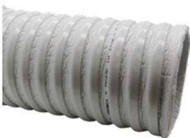
Tabazione flessibile realizzata con film di resine poliolefiniche additate con master antibatterico e antimuffa e spirale in filo di acciaio armonico. Temperature di esercizio da -20°C a +90°C. Classe di reazione al fuoco B-s2, d0. **Fornitura in pezzature da 10 m.**
