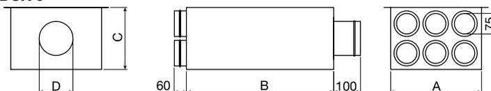
Plenum di distribuzione dell'aria dotato di 1 attacchi principali DN160, 6 attacchi secondari per tubo corrugato DN75.
