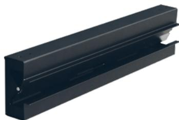
Diffusore a scomparsa in acciaio verniciato e deflettore orientabile per ottenere varie direzioni di lancio. Installazione consigliata a parete. Il diffusore deve essere montato sul proprio plenum con viti autofilettanti prima della finitura della parete.
