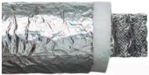
Tabazione flessibile afonica realizzata in fogli di alluminio forellinato rinforzati con un film di poliestere e supportati da una struttura a spirale in filo d'acciaio. Isolamento termico assicurato da un materassino in poliestere (spessore 25 mm). Rivestimento esterno anticondensa in tessuto di alluminio e poliestere rinforzato da un reticolo di fibra di vetro. Temperatura d'esercizio da -30°C a +140°C. Classe di reazione al fuoco B-s2, d0. **Fornitura in pezzature da 10 m.**
