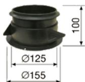
Manichetta in plastica con alette di ritenuta per pareti in cartongesso e muratura, adatta per collegamento e montaggio bocchette di ventilazione BDOP/BORP/BEH.
