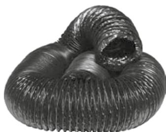
Tubo flessibile realizzato con film in resina poliolefinica e armatura costituita da spirale in filo d'acciaio armonico incorporata tra due strati termosaldati. Temperatura di esercizio da -20°C a +75°C.
