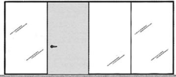
PORTA BATTENTE CON TELAIO ALLUMINIO VETRO SINGOLO
