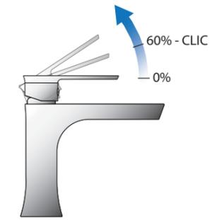
Incorpora un sistema de dos posiciones que permite diferenciar entre la zona de caudal económico y de caudal máximo. Al levantar la maneta para obtener más caudal, un tope ofrece una ligera resistencia y advierte que se pasa a la zona de máximo caudal.
