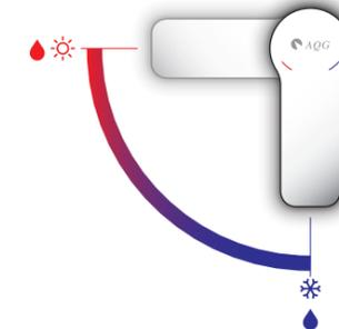
Cuando se abre el grifo con la maneta en posición central solo sale agua fría, evitando así la puesta en marcha innecesaria del calentador de agua con el consiguiente ahorro de energía. Si el usuario desea agua caliente deberá girar la maneta hacia la izquierda hasta obtener la temperatura deseada.
