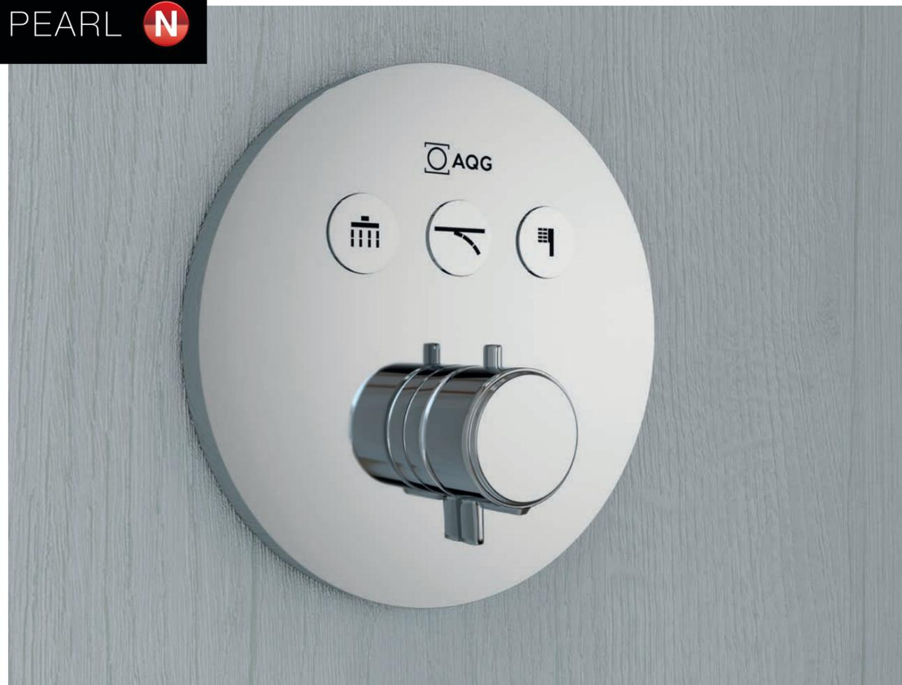
Mezclador termostático de empotrar a pared de 2 ó 3 vías con sistema de control compuesto por un mando con dos secciones giratorias independientes: la sección A regula la temperatura del agua y la sección B regula el caudal. Los botones individuales de pulsación C permiten escoger la función de ducha deseada.
