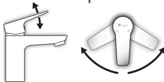
Se efectúan sobre el cartucho de los monomandos **70.000 operaciones** de apertura y cierre más giro de fría a caliente. Después del ensayo el cartucho debe funcionar correctamente
