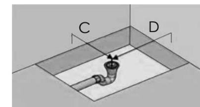
**3. Se il piatto doccia è a filo pavimento preparare un letto di malta cementizia abbastanza malleabile e ricoprire completamente il fondo dello scasso per effettuare l'installazione del bacino.**
