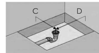
3. Se il piatto doccia è a filo pavimento preparare un letto di malta cementizia abbastanza malleabile e ricoprire completamente il fondo dello scasso per effettuare l'installazione del bacino.
