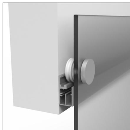
Sistema vetro con binario fissato a muro e componente rotante a vista con cover estetica sull'anta.
