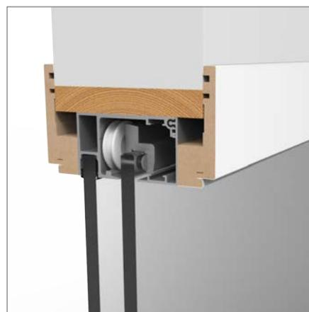
Binario doppio fissato a muro tramite viti superiori in luce con passata in legno, un'anta scorrevole e una fissa.
